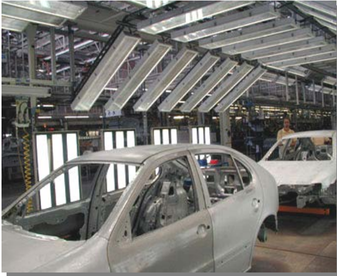
Instalación de iluminación para inspección de defectos
